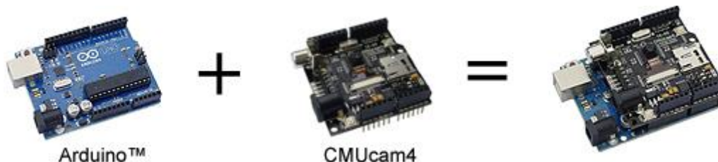
Figure 3 : Assemblage Arduino + CMUcam4 - image de lextronic.fr
