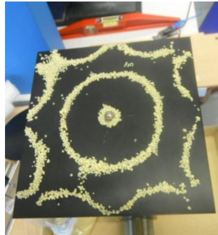
Figure 20 : visualisation des formes de Chladni à 3079 KHz
