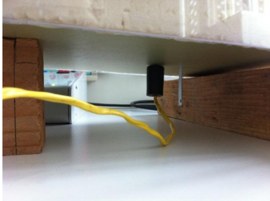
Illustration 3 Photographie du thermocouple dans la boîte
