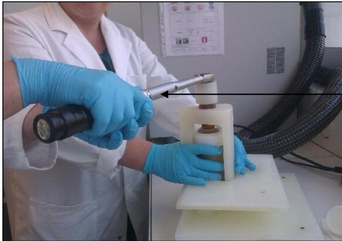
Clé dynamométrique pour ouvrir les échantillons
