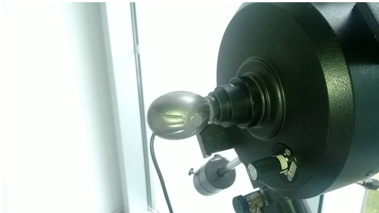
Webcam finale, adaptée au foyer du télescope.
