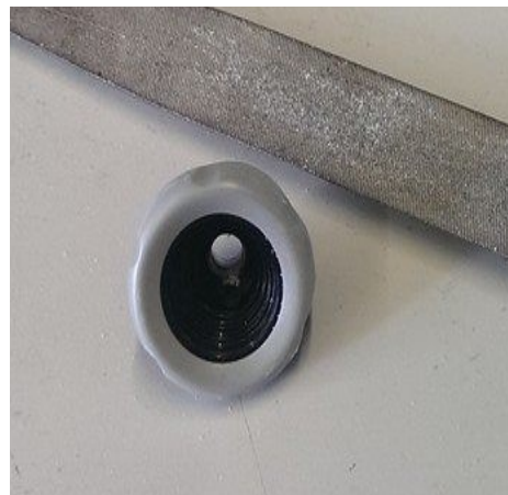
Support avec l'objectif d'origine retiré par perçage.
