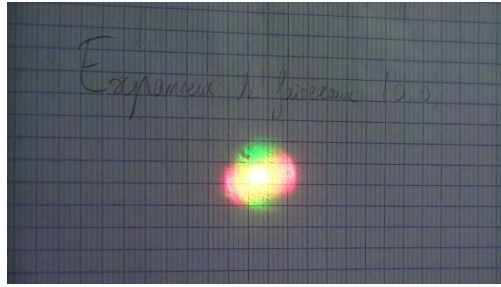
Figure 8 : lasers rouge et vert expansés et mélangés
