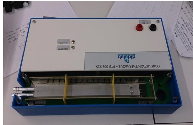
Figure 2: Boîtier chauffant et mesurant la température à différents points de l'ailette
