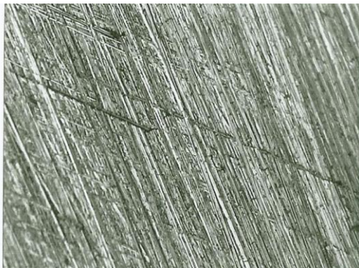
Figure 9 : Pièce de 2 euros (polissage, grains de taille 2400)
