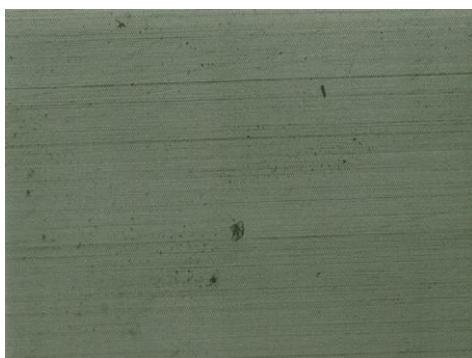
Figure 11 : Pièce de 2 euros (polissage, grains de taille 4000)
