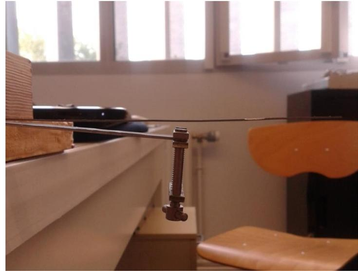
Sur la photo de droite nous voyons que la lame d'acier n'a pas repris sa forme initiale, elle est donc entrée dans le domaine plastique qui entraîne une déformation résiduelle. Nous pouvons en déduire que la lame que nous avons utilisé (acier) n'est pas un AMF.
