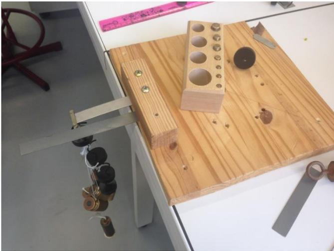
Comme le montre la photo ci-contre, nous avons inséré deux lames entre deux planches de bois : La lame la plus longue est la lame de référence qui nous permet de mesurer la distance de déformation, l'autre lame correspond à la lame étudiée.
