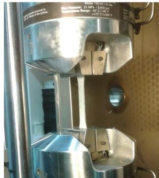
Notre matériau est fendu sur une distance de 5 mm au milieu de «l'éprouvette».
