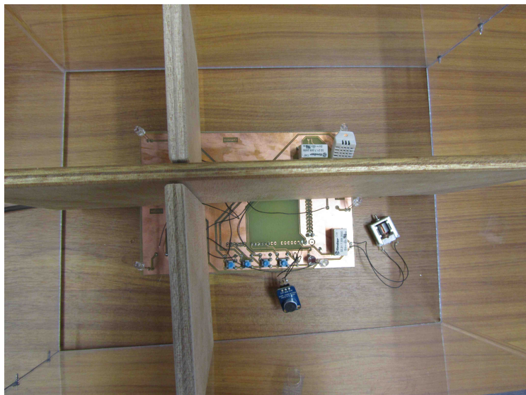
Figure 10 : Circuit fini et installé dans l'appartement
