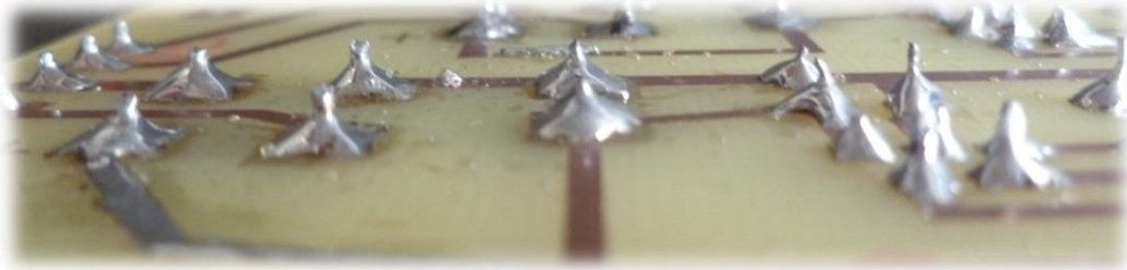
Ménisques de soudure sur l'envers du circuit imprimé
