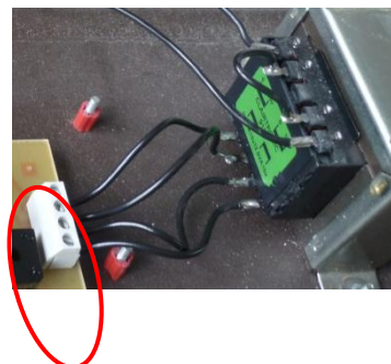
Bornier relié au transformateur et soudé au circuit imprimé
