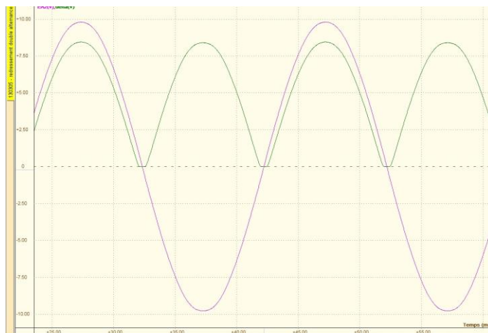
Graphe des tensions aux bornes du transformateur (courbe violette) et aux bornes du pont de diode (courbe verte)
