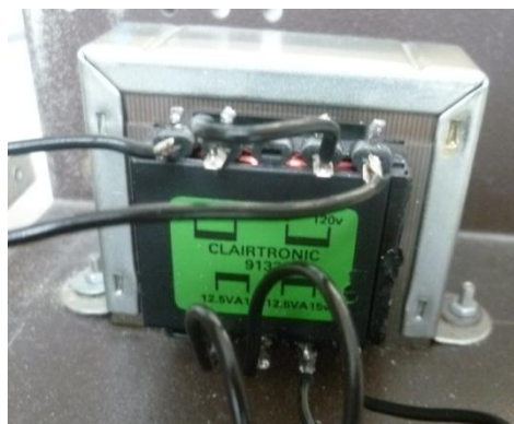
Transformateur de l'alimentation réalisée
