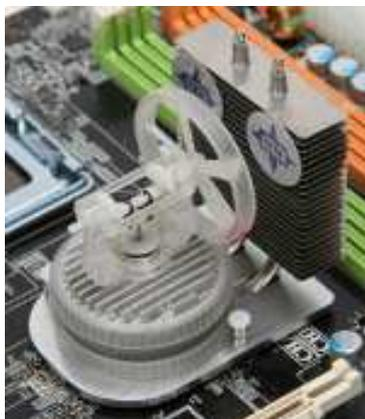
On a vu apparaître, récemment, une utilisation très spécifique du moteur Stirling pour refroidir un micro-processeur d'ordinateur. Il s'agit d'un micro-moteur Stirling qui utilise l'énergie thermique dissipée par le micro-processeur. Ce petit moteur entraîne un ventilateur qui dissipe le restant de chaleur évacué par le micro-processeur.
