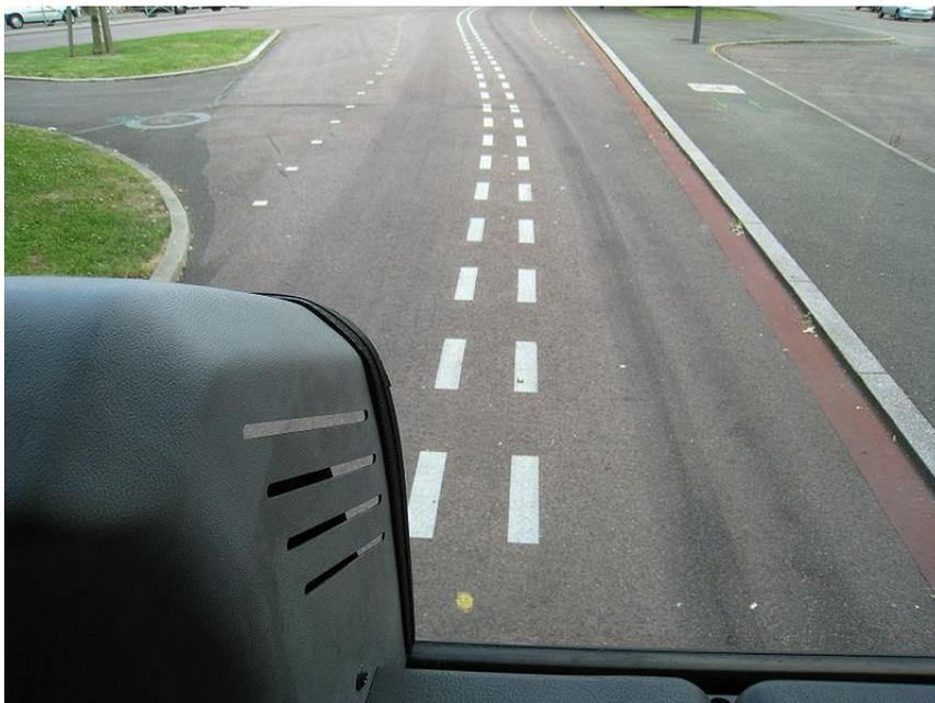
FIGURE 2.4 – Marquage lu et interprété par le guidage optique
