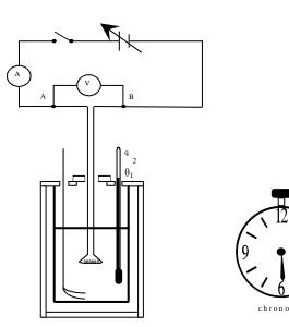
*Note* : la température sera relevée en fonction du temps grâce à la sonde de température connectée à la platine d'acquisition reliée au logiciel Latis-pro. On ne dispose pas d'interrupteur en salle de TP, on désactivera simplement le générateur de tension.
