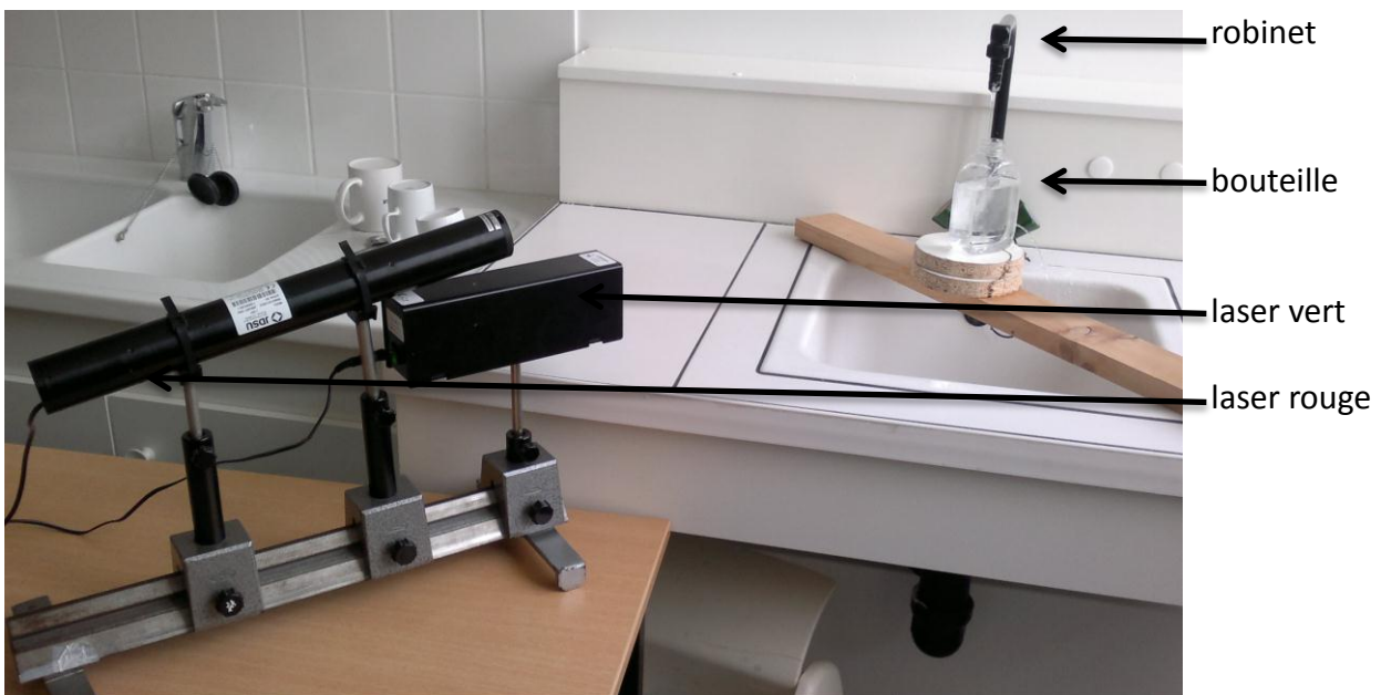
Figure 13 : Photographie du montage de fontaine laser réel
