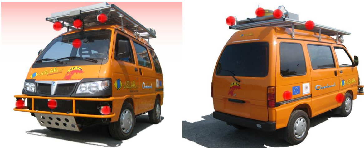
Fig 8 : L'emplacement des capteurs (caméras, radars, lasers...) sur un véhicule autonome du VIAC.
