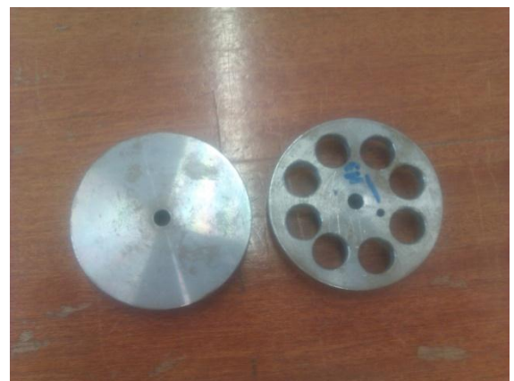
Figure 1 Etat d'une roue avant et après usinage
