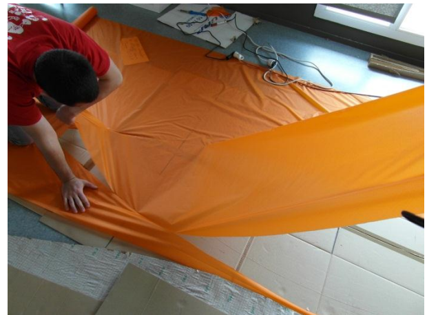
Photo 6 : découpe au fer à souder
