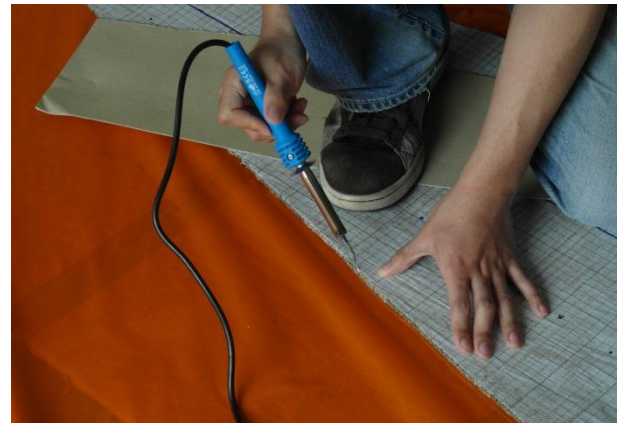
Photo 6 : découpe au fer à souder
