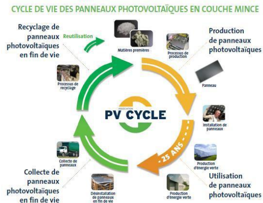
Figure 22 : Cycle de vie des panneaux PV
