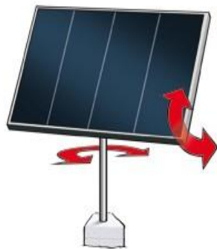
Figure 18 : Panneau solaire avec système de poursuite bi-axiale
