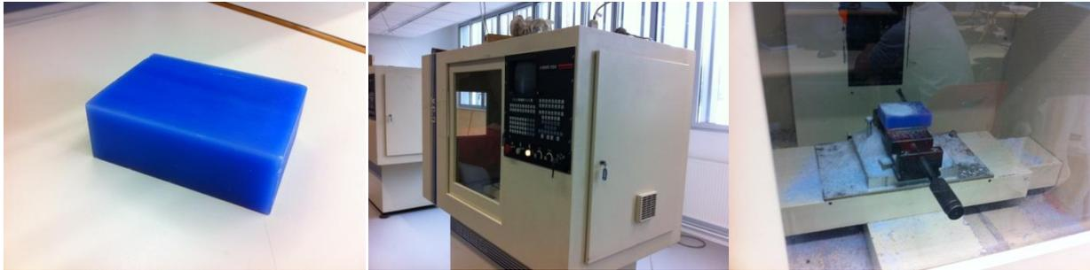
Figure 17 : Pièce brute (non usinée), machine utilisée et pièce en cours d'usinage
