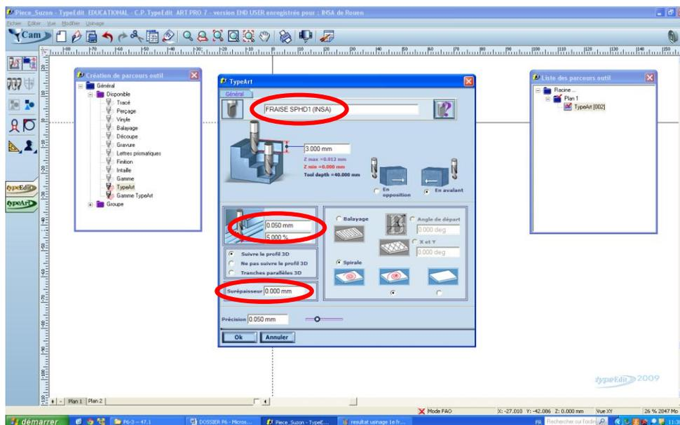
Figure 22 : Configuration de la deuxième fraise
