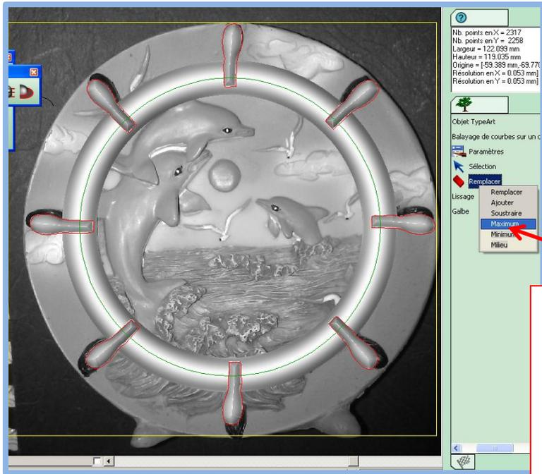
A la place de remplacer on met Maximum, cela permet au lieu de mettre la forme du pignon sur le cercle de conserver que les hauteurs maximales et donc d'obtenir des pignons qui «s'intègre» du gouvernail.
