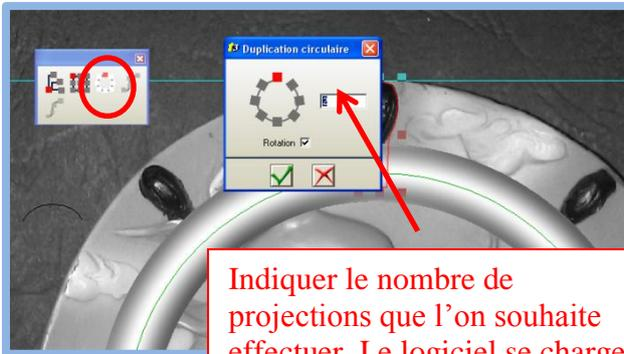
Indiquer le nombre de projections que l'on souhaite effectuer. Le logiciel se charge de répartir de façon uniforme les projections sur le cercle
