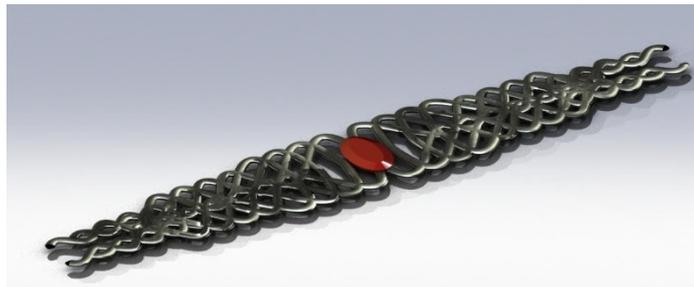
Une fois la conception sur SolidWorks terminée, il faut qu'on amène le bracelet sous Type Edit. Pour faire cela, tout est prévu car un format de sauvegarde de SolidWorks rend compatible le transfert de fichiers conçus sur SolidWorks vers les logiciels de CFAO comme Type Edit. Ce format se nomme .IGES. Nous voila parés et armés pour passer au logiciel Type Edit.
