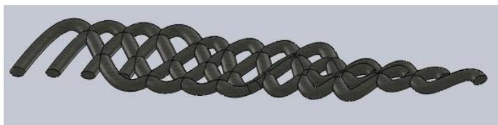
C'est l'étape suivante : la symétrie. Nous commençons par faire une symétrie d'axe horizontale, pour n'obtenir qu'une pièce (l'axe horizontal utilisé est une des faces du balayage). Nous effectuons le même travail avec l'axe vertical. Au final on retrouve une pièce avec deux axes de symétrie et nous voyons que cela ressemble à un joli bracelet. Seul problème, le centre fait légèrement vide et c'est à ce moment à qu'on se rend compte que d'y insérer une pierre serait intéressant.
