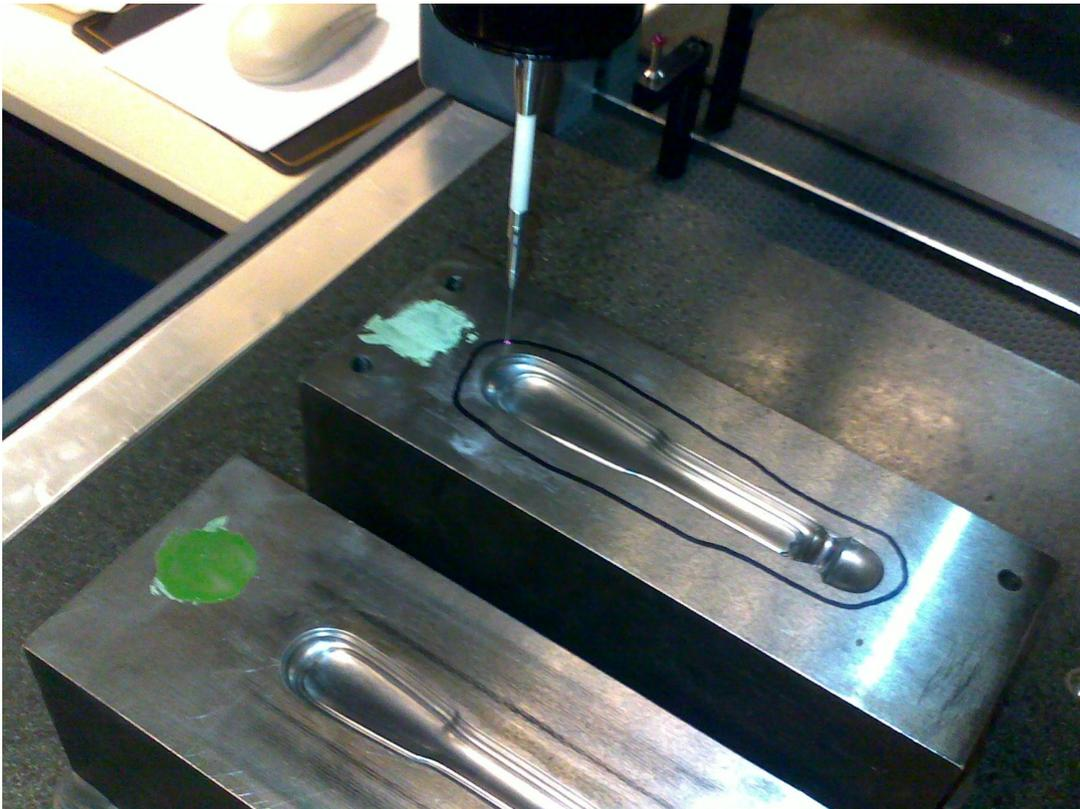
En sortie, nous obtenons un fichier contenant un nuage de points directement exploitable par un logiciel de FAO.
