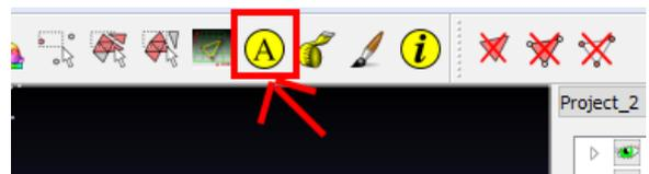
8. Choisir le modèle restant et cliquer sur le bouton Point based alignment. Une nouvelle fenêtre apparaît contenant les deux modèles. Choisir au moins quatre points correspondants sur les deux modèles par double clic sur les endroits souhaités. Cliquez sur « Start process ».
