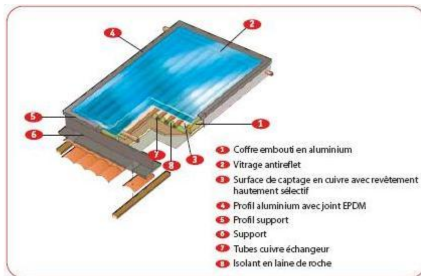
Figure 3 : Schéma d'un capteur solaire thermique vitré
