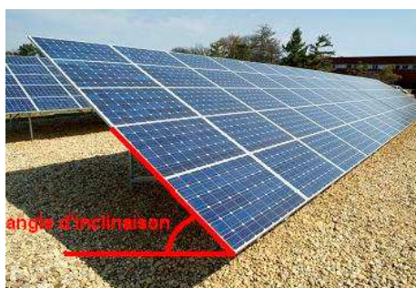
Figure 7 : Schéma représentant l'angle d'inclinaison des panneaux PV par rapport au sol.
