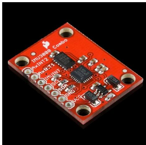
*Illustration 13: Le capteur Gyroscopique IMU3000*
