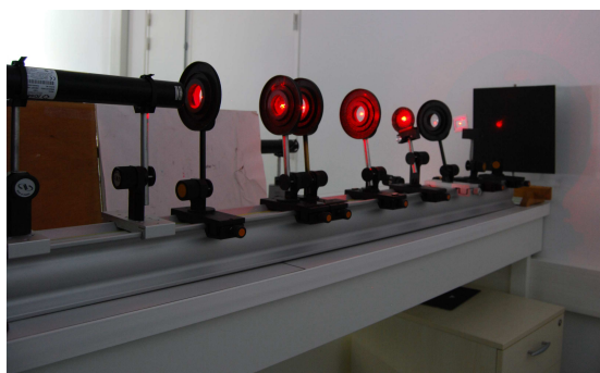
figure 42 : Annexes – Strioscopie : photo de la deuxième expérience
