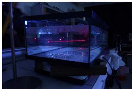
figure 30 : Annexes – Gradient de température : photo du montage avec le laser
