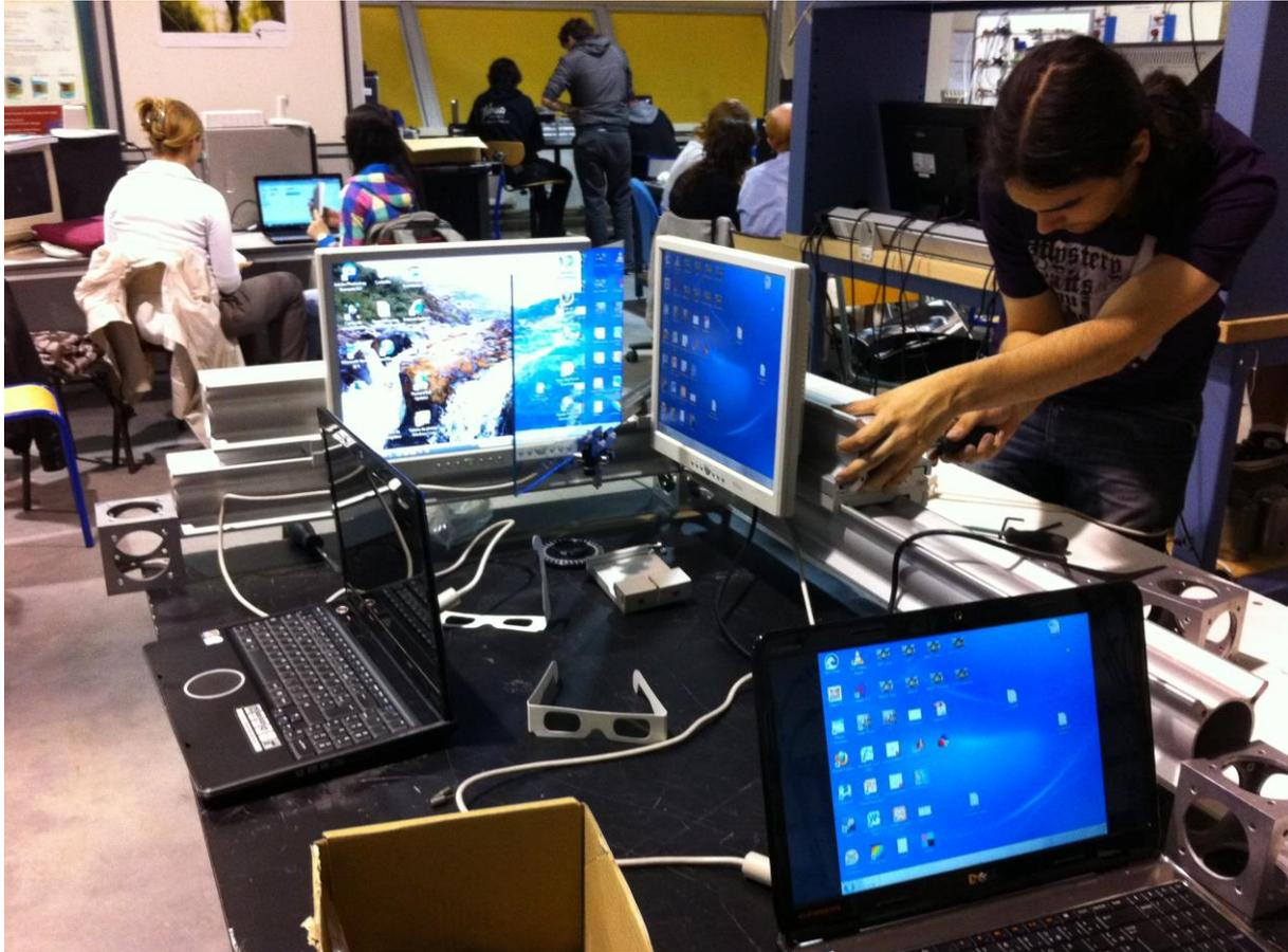
Deuxième version du montage : l'objectif était de stabiliser la barre maintenant la lame semi-transparente afin qu'elle soit strictement parallèle aux écrans. Il a fallu la fixer plus haut, aux seuls points permettant de la stabiliser de la sorte.
