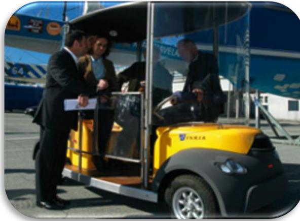
Pour M.Nashashibi, la nouveauté est le mode d'automatisation totale de la conduite, basé uniquement sur des données capteurs embarquées et sans infrastructure dédiée. Cette automatisation est fondée également sur le déploiement et l'utilisation des télécommunications sans fil. De même, c'est la première fois que les navettes automatiques partagent réellement la route avec les riverains et les voitures ordinaires.
