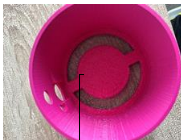
Absence de trous pour la fixation du servomoteur
