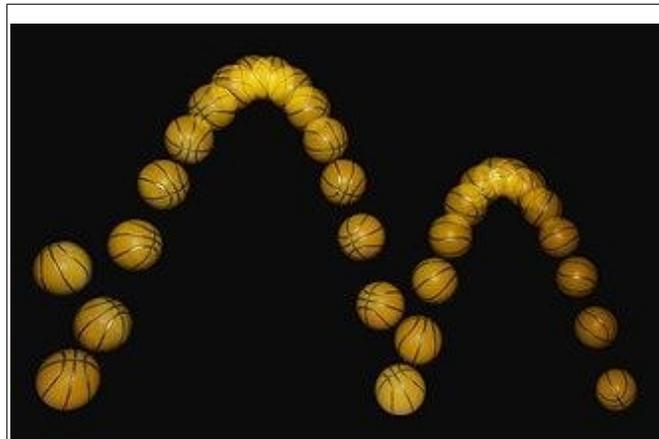
*Figure 50: Trajectoire d'une balle vue à travers d'un troboscope avec une caméra*
