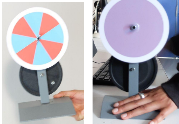
figure 12 : Capture de la couleur perçue lors de la rotation du disque
