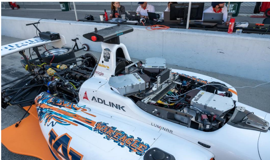
figure 3 : Voiture de l'Indy Autonomous Challenge et de ses composants.[8]
