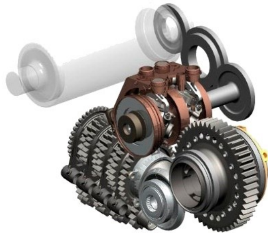
Figure 4: Le système CVT
