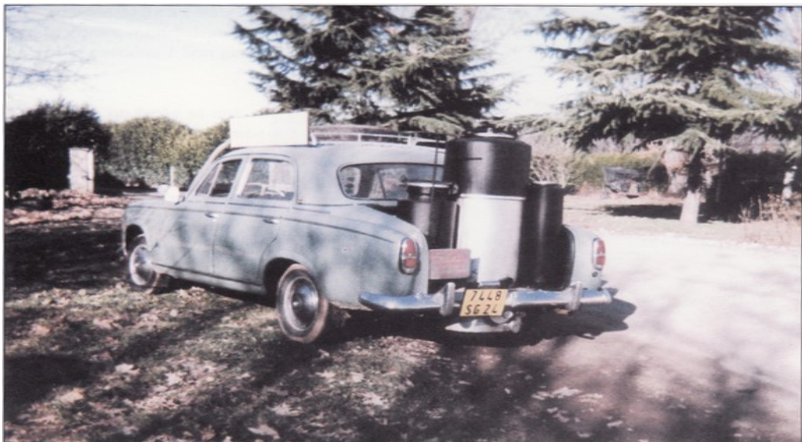
Illustration 15: Vue latérale d'une peugeot 403 à gazogène à bois (fabrication maison) qui roule régulièrement.
