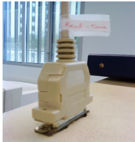
Figure 8 : Etiquetage des câbles
