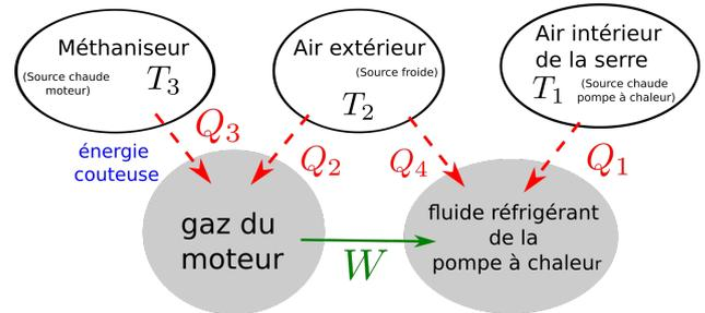
2) La variation d'énergie interne étant au nulle au cours d'un cycle, le premier principe de la thermodynamique pour le gaz du moteur donne :
