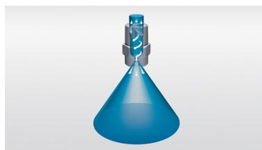
FIGURE 2.3 – Buses à cône complet
