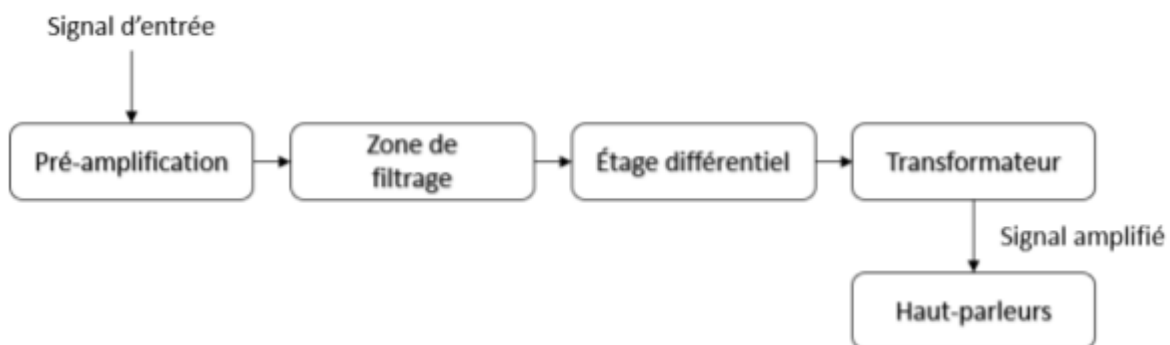
Schéma résumé des parties de l'amplificateur
