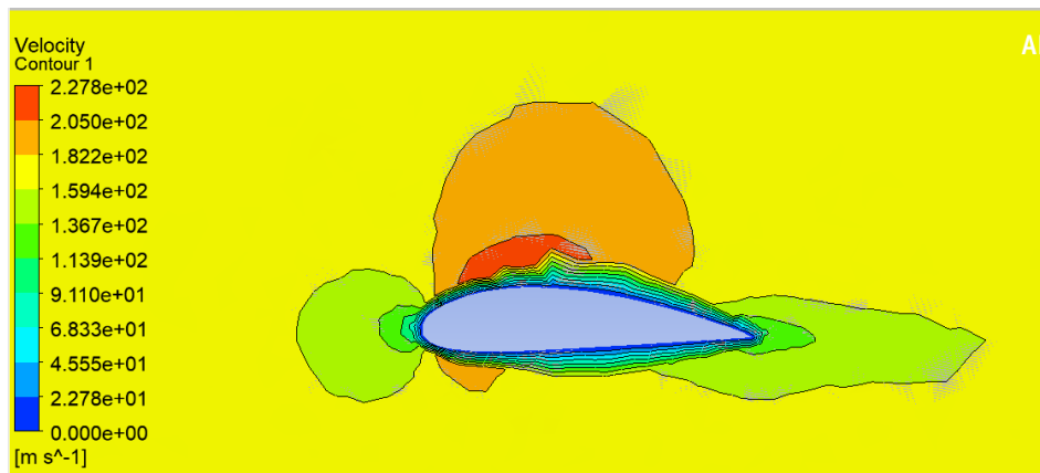
FIGURE 19 – Graphe de la vitesse pour un plan au milieu de l’aile sans winglet
