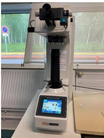
Figure 10 : Machine de microdureté
