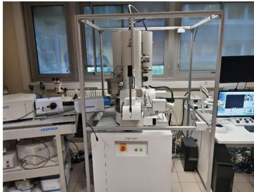
Figure 9 : Microscope électronique à balayage
