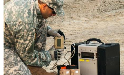
Figure 2 : Le générateur Squad Power Manager Protonex
