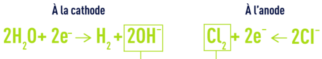
Figure 3 : Equation d'oxydo-réduction de l'eau salé
