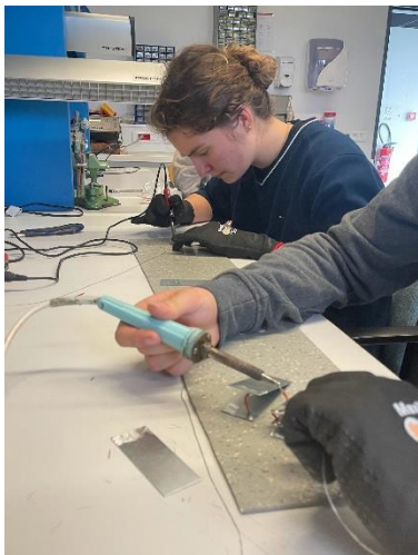
Figure 9 : Soudage des cathodes et des anodes
