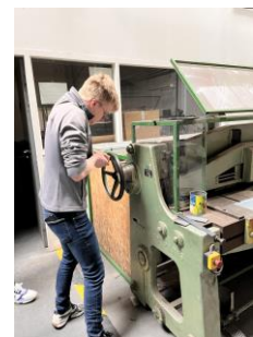
Figure 10 : Découpage des plaques de métal
