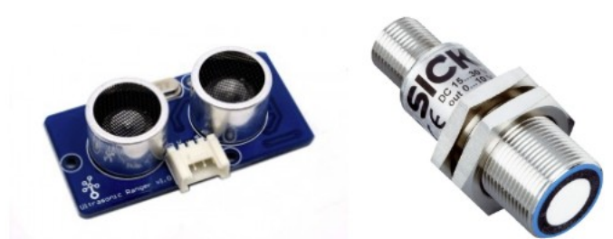
Figure 11: Différents capteurs ultrasonores vendus dans le commerce [27]
