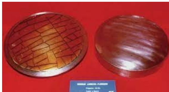
Figure 1: Le sondeur Florisson-Langevin à l'ESPCI (Ecole Supérieure de Physique et de Chimie Industrielles de la ville de Paris)
