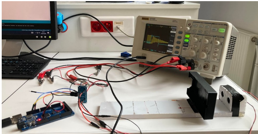
Figure 35: Chaîne de mesure de l'expérience de l'oscilloscope
