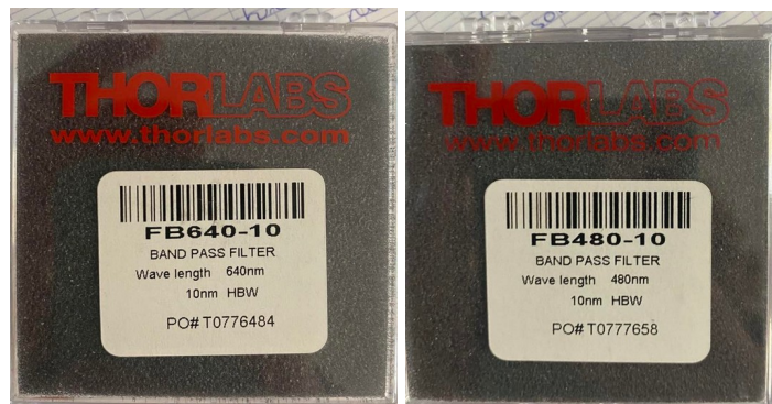
Figure 20 : Boîtiers des filtres avec leurs caractéristiques
