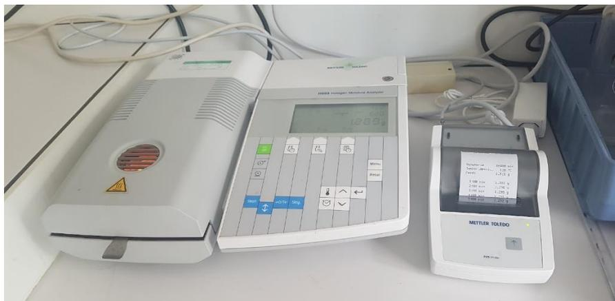
Image de la thermobalance utilisée
