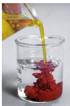
Figure 7 : Chromate de potassium (solution jaune et précipité rouge brique)
