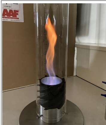
Figure 8 : photo de la flamme du brûleur modélisé avec une augmentation du nombre d'ailettes
