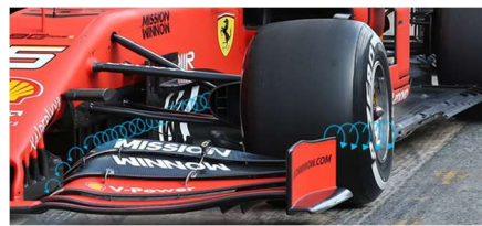
Figure 2.8 : Aileron avant d'une Formule 1 de l'écurie Ferrari
