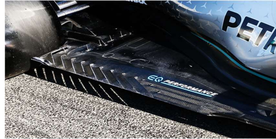
Figure 2.13 : Fonds plats d'une F1 de l'écurie Mercedes
